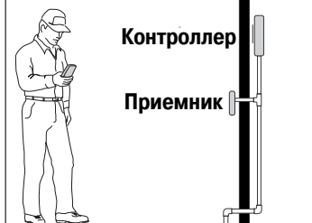
Установка снаружи помещения (только временное подключение приемного устройства)
